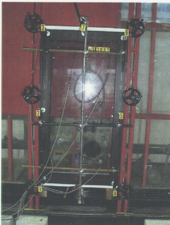
Foto 1: Schema di applicazione dei trasduttori
